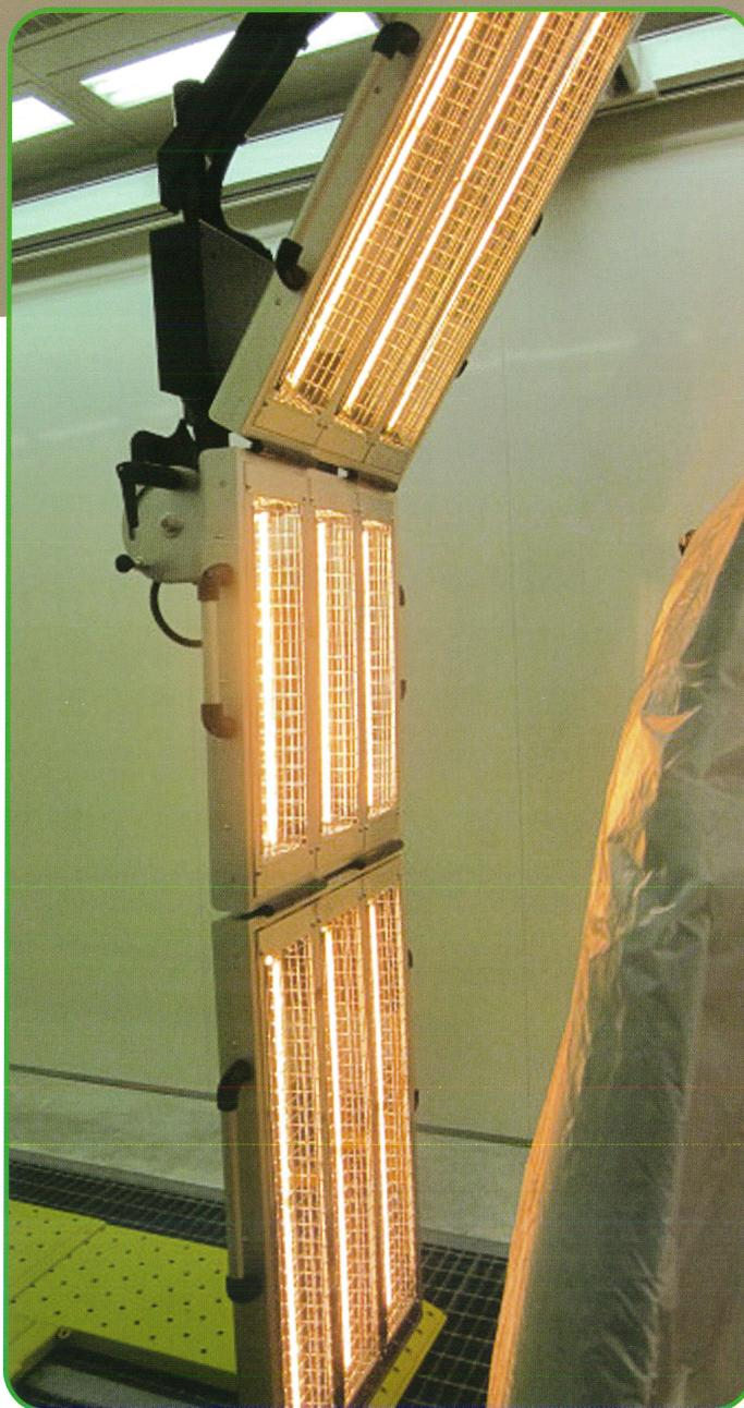
SURYAは、赤外線テクノロジーを採用した画期的な半自動塗料乾燥システムで、スピーディな乾燥を可能にします。
